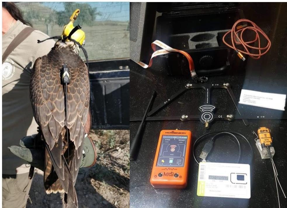
Slika 74. Uređaj za telemetriju, odašiljač montiran na pticu
